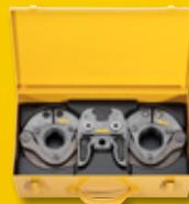
REMS Pressringe (PR-3S) mit 3 an einem gelenkigen Ring schwenkbar gelagerten Presssegmenten für anspruchsvolle Pressungen großer Dimensionen. Optimale Pressung durch radial gesteuerte Bewegung der Presssegmente. Presskontur M für Pressfitting-Systeme Geberit Mapress und geeignete andere Systeme.
